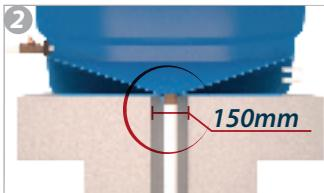
2. Deixar uma espuma (furação) de aproximadamente 150mm no meio da base de concreto para saída central do fundo do reservatório (luva de 50mm).
