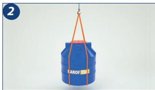
**2.** O manuseio do tanque Bakof deve ser cuidadoso, sem impactos e com o mesmo totalmente vazio. O içamento deve ser feito através dos ilhoses instalados na parte superior do tanque ou através de cintas de elevação;
