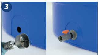
**3.** Caso seja necessário a instalação de flanges para o visor de nível e o registro de saída, efetuar as furações somente nos locais indicados (faces planas), utilizando serra-copo compatível com flange a ser utilizada;
