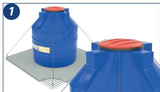
**1.** Apoie e instale o tanque sobre uma superfície plana, lisa e nivelada, de concreto armado ou metálica, de acordo com orientação do engenheiro responsável, fixando-o firmemente à base. O fundo do tanque deve estar totalmente apoiado sobre a base. Fixe ou amarre o reservatório utilizando os ilhoses na parte superior do tanque ou passando um cabo de aço ao redor do bocal de inspeção, caso o tanque não tenha os ilhoses;
