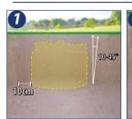
1. Escavar o local de instalação com paredes em inclinação de 10° a 45° e nivelar a terra na base (cuja dimensão deve ser 10 cm maior que a base do produto).
