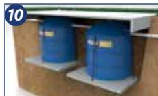
10. Não deve haver trânsito sobre o equipamento. Caso o Retator e Biofiltro Bakof Tec esteja instalada em local de circulação, deve ser construída uma laje que não esteja apoiada diretamente sobre o produto.
