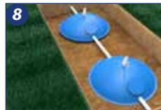
8. Preservar fácil acesso à tampa de inspeção para eventual manutenção e limpeza do equipamento, cuja periodicidade deve ser a cada 12 meses, ou inferior conforme necessidade. Não deve haver aterro sobre a tampa de inspeção, sobre o equipamento o máximo de 30 cm.
