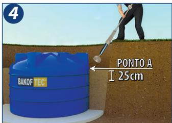
4. Utilizar terra peneirada (livre de pedras ou objetos pontiagudos), areia ou pó de brita adicionados a cimento ao traço 1:10 como aterramento e efetuar a compactação do preenchimento gradativamente, por camadas de 25 cm, até a nervura superior da cisterna (ponto "A" indicado na figura).
