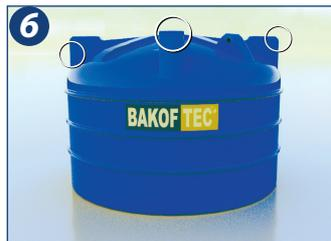
6. Efetuar as furações para entrada, saída e respiro nas partes planas da Cisterna Bakof destinadas a essa finalidade e realizar as conexões utilizando anéis de vedação.
