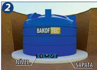
2. Construir uma sapata nivelada em concreto armado que servirá como base para a Cisterna Bakof. A base deverá ser lisa, nivelada e isenta de irregularidades que possam danificar o reservatório. A cisterna deve ser posicionada no centro da base de concreto.
