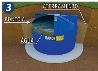
3. Encher a Cisterna Bakof antes de efetuar o aterramento, com água, até a nervura superior do reservatório (ponto "A" da Figura). Deixando-a em repouso por no mínimo 24h para assegurar que a estanqueidade tenha sido preservada durante a movimentação, instalação e conexões.
