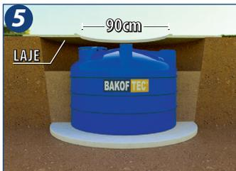
5. A laje de fechamento da escavação será definida pelo engenheiro responsável da obra e esta deverá conter abertura de inspeção de, no mínimo, 90 cm de diâmetro, que permita acesso à Cisterna e ao sistema hidráulico para realização de inspeções, manutenção e limpeza. E tampa para a abertura de inspeção que não permita a entrada de água na escavação.
