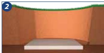
**2.** Construir uma base em concreto armado nivelada e lisa que servirá como apoio para a Cisterna TC Bakof e para sua ancoragem.
