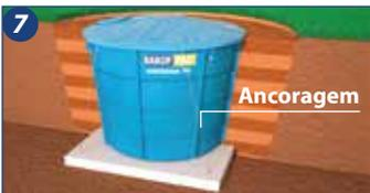
**7.** Em terrenos arenosos, movediços e de lençol freático superficial, além de sapata, realizar a ancoragem da Cisterna TC.
