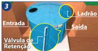
**3.** Efetuar as ligações das tubulações nos locais indicados no produto, entrada (E - Ø100mm), saída (S - Ø32mm) e ladrão (L - Ø100mm) da Cisterna TC. Verificar se a válvula de retenção e o freio d'água estão conectados.
