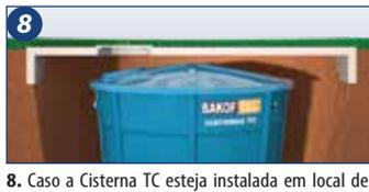
**8.** Caso a Cisterna TC esteja instalada em local de circulação de veículos, intensa circulação de pedrestes ou com mais de 30cm de aterramento sobre a tampa, deve ser construída uma laje estruturada que não esteja apoiada sobre o produto. Recomenda-se usar filtro de folhas e descarte da água da chuva, Bakof Tec conforme ABNT 15.527.
