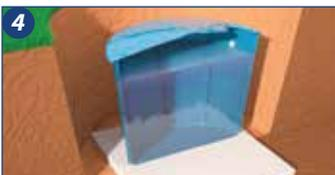
**4.** Encher a Cisterna TC antes de efetuar o aterramento, deixando em repouso por no mínimo 24h para assegurar que a estanqueidade tenha sido preservada durante a movimentação, instalação e ligações.
