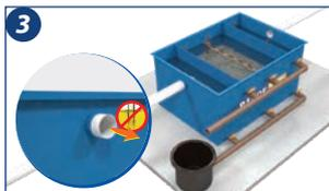
3. **Atenção:** Antes de iniciar o uso, preencher o separador com água limpa verificando se não há vazamentos, evitando a contaminação com óleo do local de destino do efluente.
