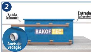
2. Realizar as conexões da entrada (afluente) e saída (efluente) no equipamento utilizando tubulação com diâmetro de 100 mm e anéis de vedação. Verificar toda a tubulação evitando qualquer eventual vazamento.
