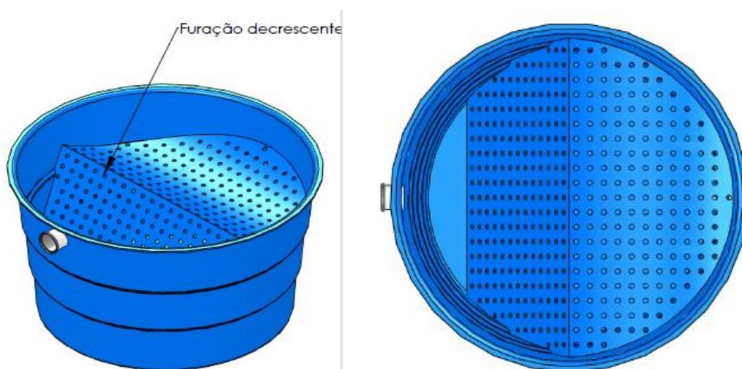
Figura 2: Caixa de Gradeamento Retangular.
