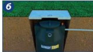
6. Caso o sistema seja totalmente enterrado ou instalado em local de intensa circulação (ou circulação de veículos), deve-se construir uma laje de sustentação que não seja apoiada no equipamento, além de manter fácil acesso à sua tampa de inspeção para eventual manutenção e limpeza do equipamento, cuja periodicidade deve ser a cada 12 meses, ou inferior conforme necessidade.
