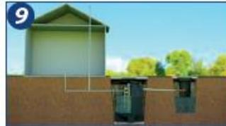
9. O tratamento aeróbico é natural e inerente a formação de gases. O responsável pela instalação hidráulica da residência deve construir a tubulação de forma a conduzir para o sistema de ventilação do esgoto sanitário os gases, utilizando as técnicas necessárias.
