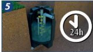
5. Com a tampa lavada, encher o Multi Biodigestor com água por meio da tubulação de saída até retornar a água pela própria tubulação, garantindo assim que o filtro não sofra pressão ascendente. Após efetuado esse processo, preencher o corpo do Multi Biodigestor por meio da tubulação de entrada, observando que o registro de remoção de lodo esteja fechado. Deixar o sistema em repouso por 24 horas para assegurar que a estanqueidade do equipamento tenha sido preservada.
