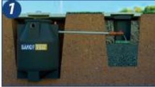
1. O Multi Biodigestor Bakof Tec deve ser instalado externamente.
