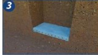
3. Construir uma base nivelada e lisa em concreto armado que servirá como apoio para o Multi Biodigestor.
