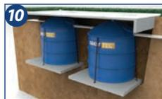
10. Não deve haver trânsito sobre o equipamento. Caso o Reator e Biofiltro Bakof Tec esteja instalada em local de circulação, deve ser construída uma laje que não esteja apoiada diretamente sobre o produto.
