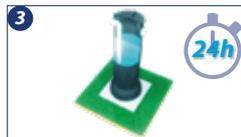
**3.** Antes da instalação é necessário realizar o teste de estanqueidade do produto. Encha a cisterna e deixe-a em repouso por 24 horas.
