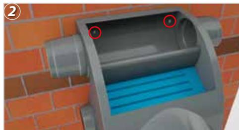
2. Fixe o Separador de Folhas Bakof em um suporte ou diretamente na parede. Efetue a furação na parte traseira do equipamento utilizando internamente parafuso de 6,0 x 35 com arruelas e bucha n° 8.
