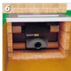
6. O Filtro Separador de Folhas Bakof pode ser instalado tanto superficialmente quanto enterrado (neste caso dentro de uma caixa de inspeção e com as tubulações devidamente direcionadas para destinos finais).
