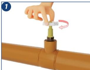
1. Feche o registro do hidrômetro. Você pode instalar o Filtro Big Tec antes da caixa d'água, junto ao cavalete (após o hidrômetro) ou em piscinas.
