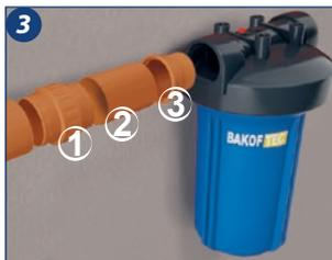
3. Em um dos lados da união (1) cole o tubo de entrada da água e do outro, fixe um pedaço de tubo (2) medindo 5 cm – (o comprimento dependerá da instalação). Cole na outra extremidade do tubo o adaptador soldável (3) (lado liso). Faça o mesmo encaixe de peças no outro lado da carcaça.
