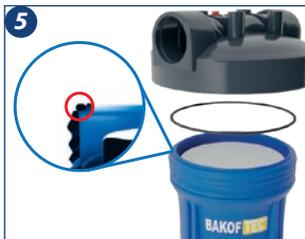
5. Encaixe o copo do filtro observando se o anel o'ring (anel preto) está devidamente encaixado no copo.
