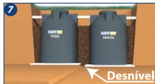
**7.** Utilizar traço de cimento: terra (1:10), livre de pedras ou objetos pontiagudos e efetuar a compactação a cada 25 cm. O processo de aterramento e compactação não deve ser mecanizado.
